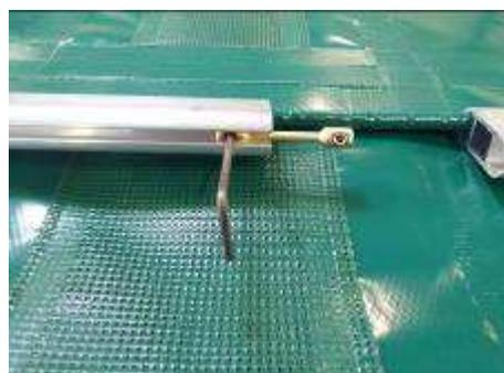
Relier les 2 profils entre eux avec l'insert double et la clé Allen.
