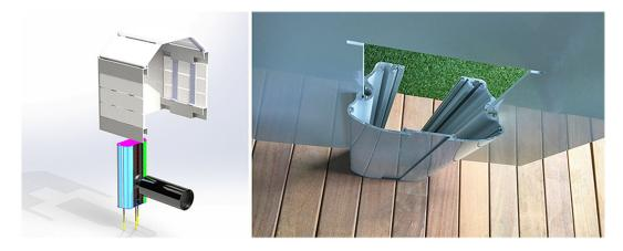
Placer et visser les plaques de capots sur les potelets pour condamner le déplacement des consoles.
